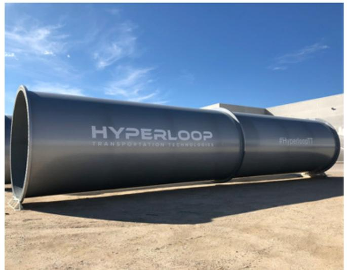
offre un'eccellente ritenzione di colore e brillantezza. Per quanto riguarda le superfici interne, sono state protette con una mano di Hempel Galvosil 15700, un silicato di zinco inorganico, bi-componente, che offre una eccezionale resistenza contro ogni tipo di danno.
